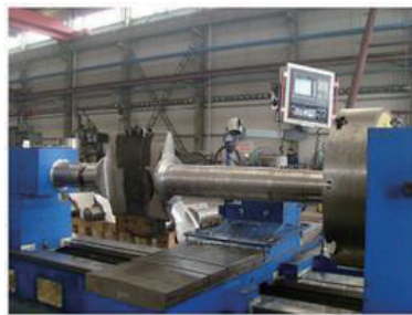
图6 未使用工装加工导叶
