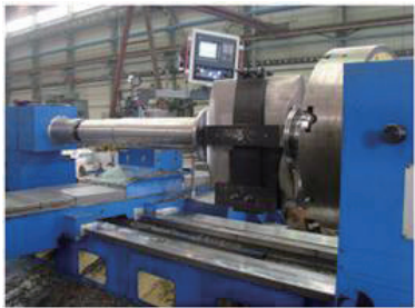
图7 使用工装加工导叶
