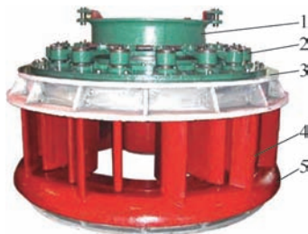
图1 导水机构 1.控制环 2.导叶臂 3.顶盖 4.活动导叶 5.底环
