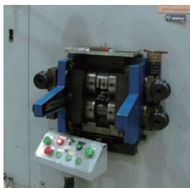
(b) 叶片型面辊轧成型示意图
