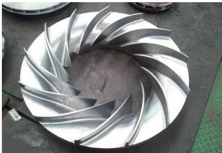
图7 叶片铣制在盖盘上的三元叶轮
