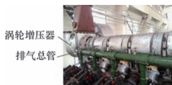
图2 排气总管在内燃机中的安装位置
