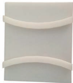
图5 3D打印机完成的加强结构
