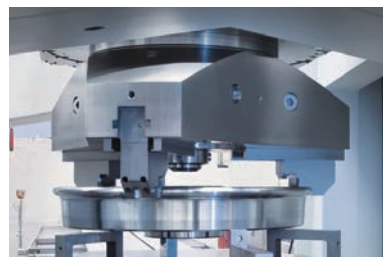
图4 VLC1200车削中心加工火车轮示意
