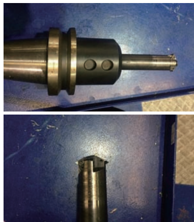
图4 M36螺纹孔加工用机夹式螺纹铣刀
