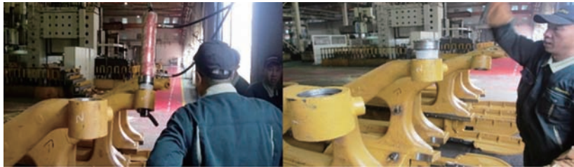
图8 低温无法压入现象
