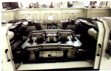
图2 铣拳头面、钻主销孔组合机床
