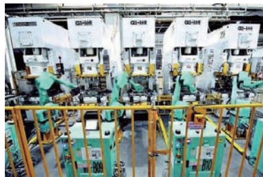
图2 机器人+锻压系统集成
