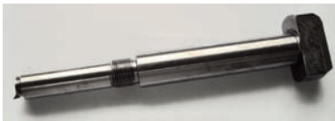
图7 损坏的T形拉杆
