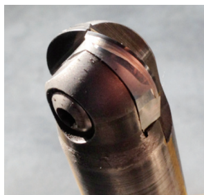
图7 CBN数控精加工刀具
