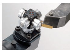
(c) 刀具对刀仪可以有效补偿刀具磨损引起的误差值, 保障加工精度值
