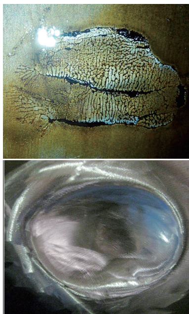
图3 聚集型裂纹及局部打磨修复实例 通常检测工作包含三步：
