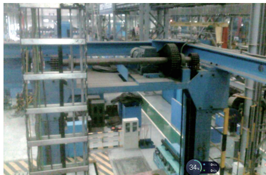
图2 操作站水平（左右）移动机构
