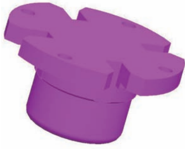
图9 凸模溢料结构图
