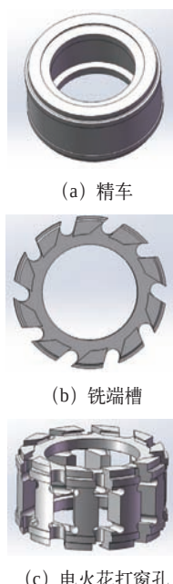
图2 离合器分离环部分加工流程
