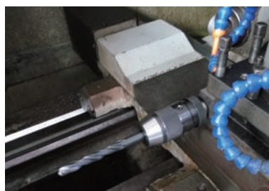
图6 工装安装到刀架上示意图
