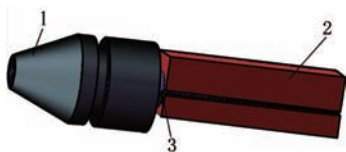
图2 安装于车床刀架的直、锥柄钻孔工装
