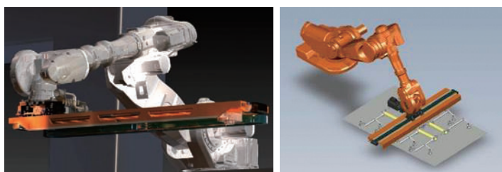
图2 配置直线七轴装置的工业机器人
