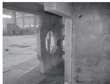
图5 机身前额板后侧补焊加强衬板
