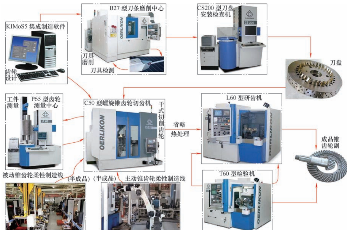
图7 Oerlikon锥齿轮副智造系统示意
