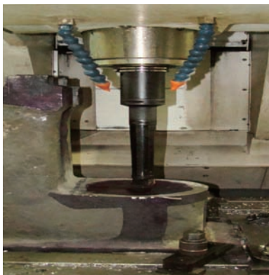
图5 弹簧座孔螺旋插补铣削实例
