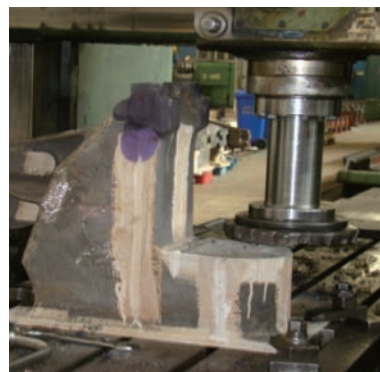
图4 主轴过渡套使用实例
