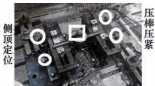
图2 原二次加工工装的装夹示意图
