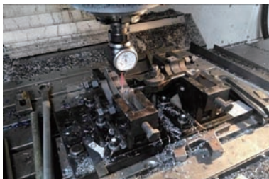
图3 对原工装进行找正检查示意图
