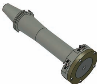
(a) 径向可伸缩式背面铣刀收缩状态
