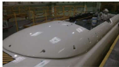
图5 平顶受电弓区域导流罩安装
