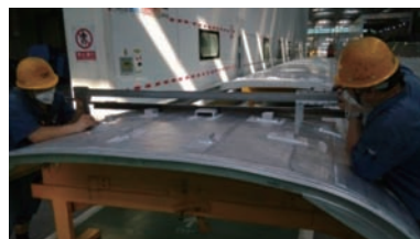
图4 导流罩锁紧块宽度方向检测
