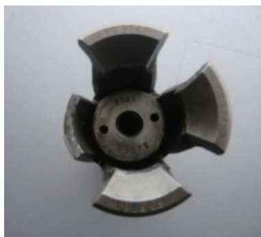
图1 拉爪断裂状态
