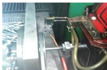
图7 气门杆端冲击/仿形淬火感应器
