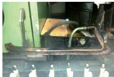
图8 气门杆部淬透连续淬火感应器
