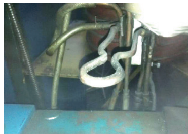
图6 单圈气门锥面淬火感应器
