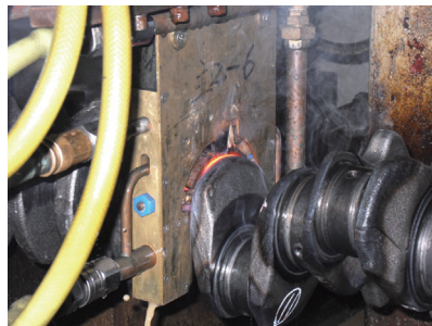
图6 曲轴感应淬火及所用感应器
