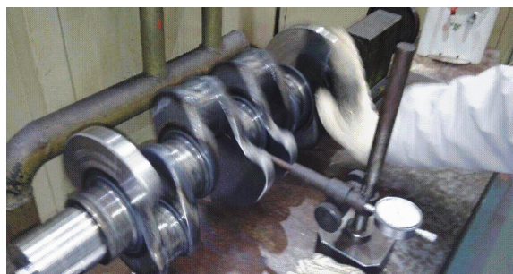
图2 曲轴变形量的测量
