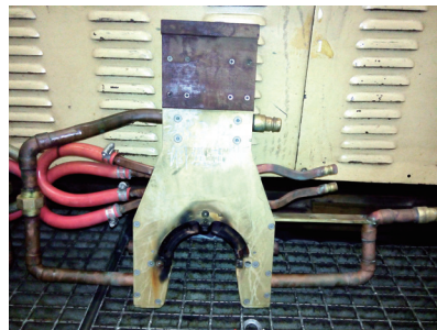
图6 曲轴感应淬火及所用感应器
