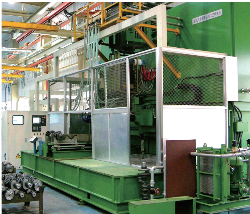
图1 曲轴感应淬火机床
