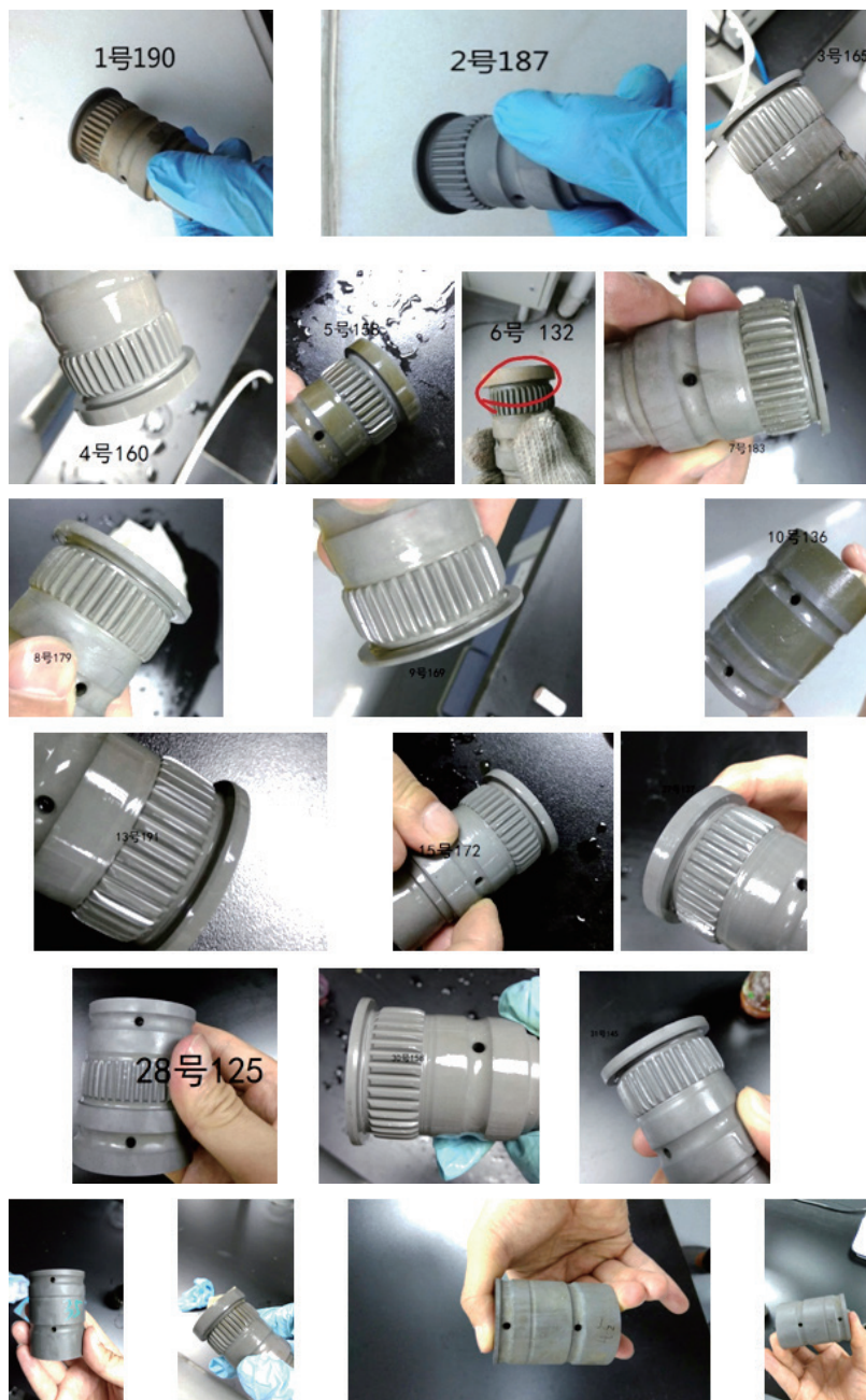
图3 校直裂纹实物照片 酸煮试验检测结果
