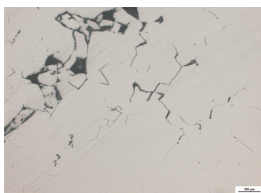
图10 断口附近裂纹形貌 (100×)
