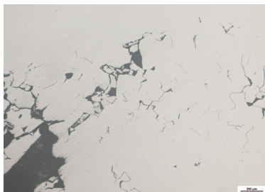
图9 断口附近裂纹形貌 (50×)
