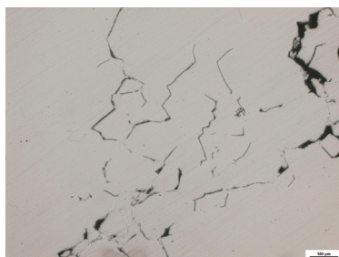
图12 断口附近裂纹形貌 (100×)
