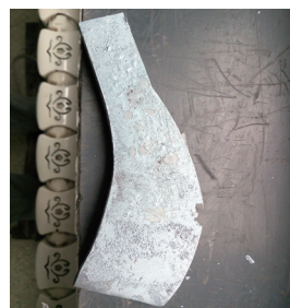
图8 第一次变形处理未开裂实物
