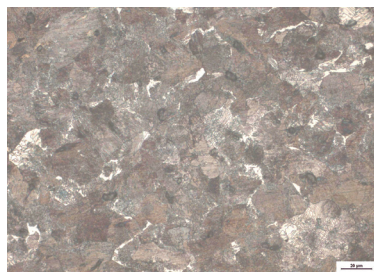
图5 原材料基体组织形貌（500×）
