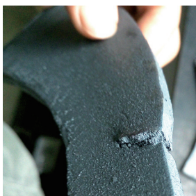
图7 第一次变形处理开裂实物
