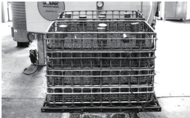
图6 合金料件组件和测试样品
