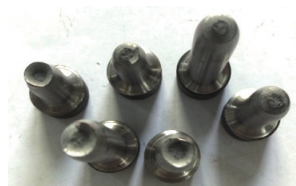
图11 工艺2试样试验后拉伸试样断口
