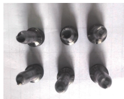
图10 工艺1试样试验后拉伸试样断口
