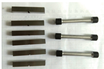
图5 试验前力学性能试样形貌
