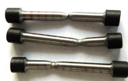
图7 工艺2试样试验后拉伸试样外貌
