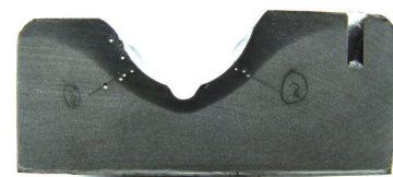
图7 50Mn圆弧试样切面
