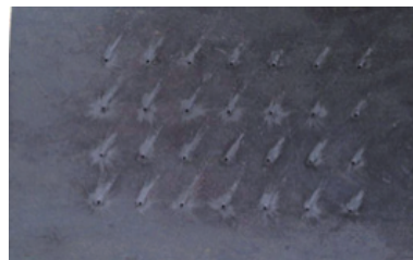
图5 激光在钢板上划线打点试验状态
