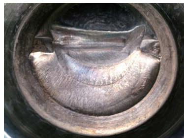
图2 开裂断口处(实物)
