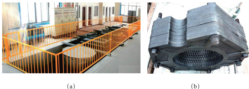
图2 QPQ处理所用设备以及QPQ处理后的锥环支板
