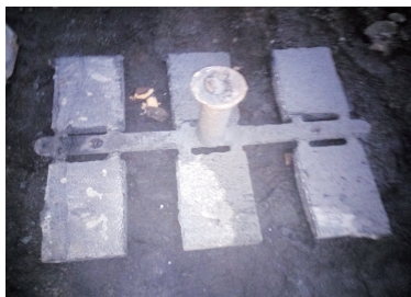
图8 大平面部位的掉砂、粘砂缺陷
