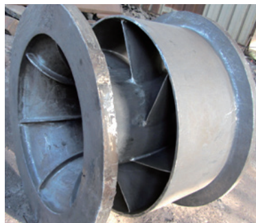
图3 导叶体铸件毛坯
