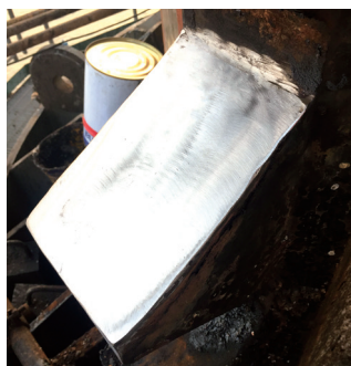
图5 磨损齿条修补后
