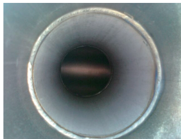
图4 打底焊内部焊缝效果
