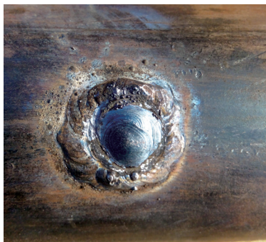
图5 第一层封堵层焊道
