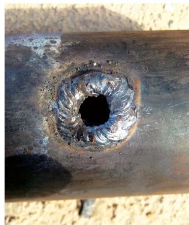
图4 右半圈焊接实例
