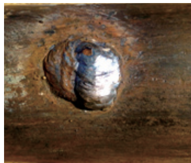
图6 第二层加强层焊道
