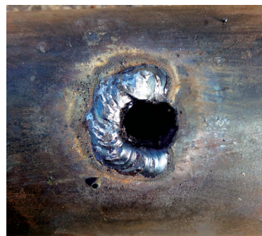
图2 左半圈焊接实例
