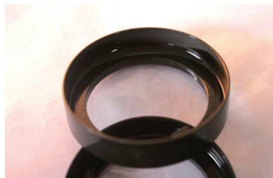
图2 止动垫圈氧化磷化后T1面有灰白花斑
