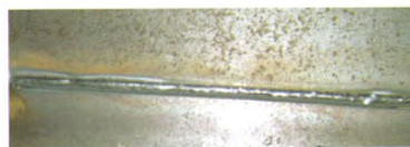
图3 对接焊缝试板
