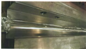
图1 枕梁型材组对后的X形焊缝坡口
