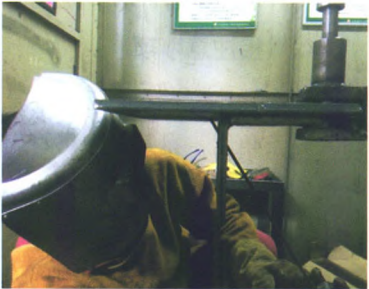
图4 焊接时焊工视线位置
