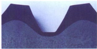
图4 外花键轴感应淬火后切片宏观照片
