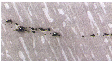
图5 夹杂呈链状分布SEM形貌
