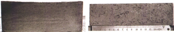
图1 径向和周向冷酸洗低倍检验面形貌
