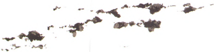
图2 单个大当量探伤缺陷在光学显微镜下形貌
