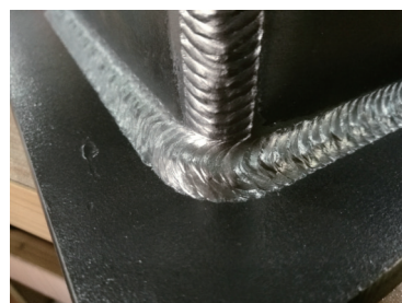
图4 衔接程序点重叠区长度为2~3mm的焊缝形貌
