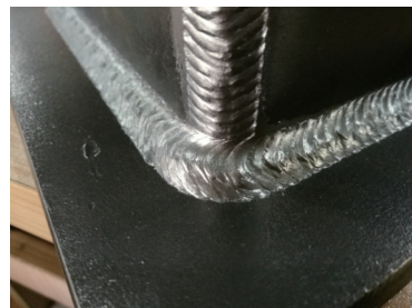
图8 焊缝成形良好
