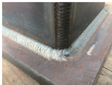
图7 T形接头焊缝上位置出现咬边
