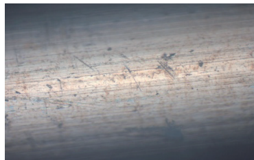
图9 新工艺生产焊丝的铜层
