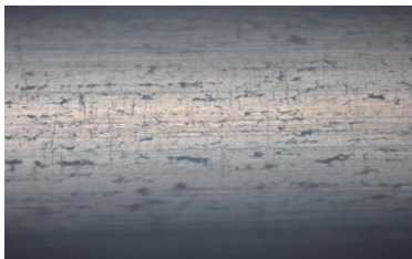
图8 常规工艺生产焊丝的铜层
