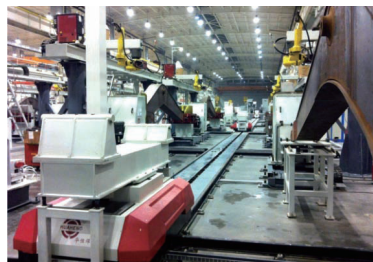
图11 挖掘机动臂自动化焊接生产线
