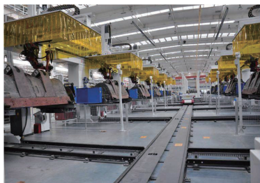
图10 装载机铲斗自动化焊接生产线
