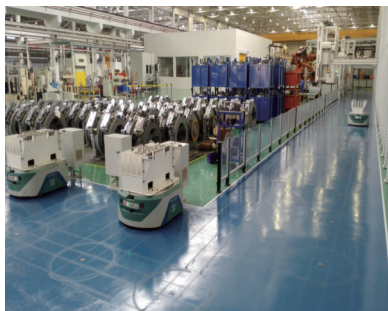
图6 二维码导航背负式转运机器人
