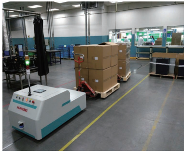
图7 磁条导航牵引式转运机器人
