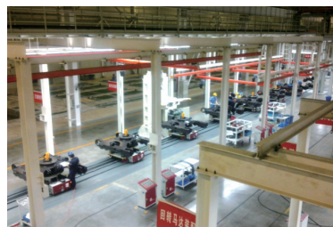
图13 挖掘机下车架自动化装配生产线
