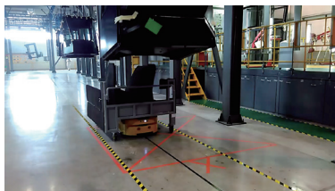
图8 磁条导航潜伏牵引式转运机器人
