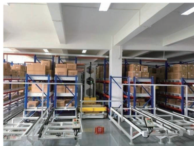
图5 堆垛式机器人仓储系统
