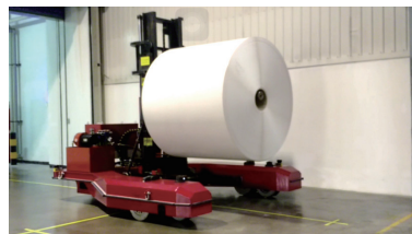
图9 色带导航夹抱式转运机器人
