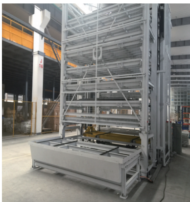
图2 板材立体仓库
