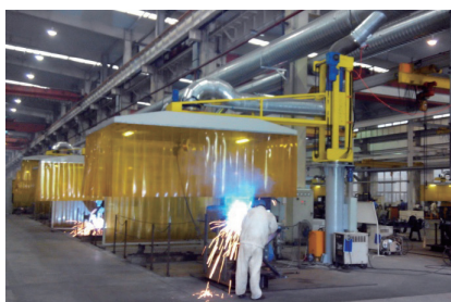
图7 机器人焊接烟尘顶吸罩
