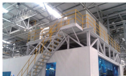
图11 汽车焊接生产线除尘工作间
