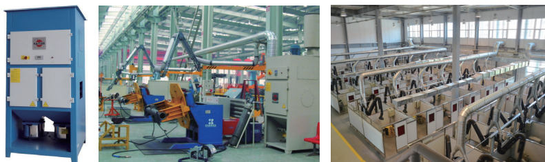
图4 多工位集中式焊烟净化系统
