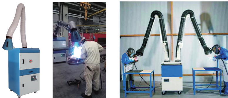
图3 移动式焊接烟尘净化器单、双工位使用
