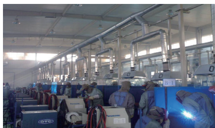
图10 工作间+顶吸罩捕捉形式
